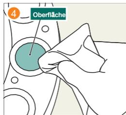
Wischen Sie die Oberfläche (schwarzer Bereich) jeder Platte ab. Da dieser Bereich Messwerte beeinflusst, wischen Sie vorsichtig, damit keine Kratzer entstehen.
