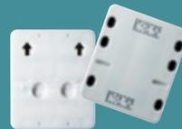
Potentiometrische Testplättchen mit ionenselektiven Elektroden für Na, K und Cl.
