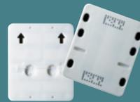
Potentiometrische Testplättchen mit ionenselektiven Elektroden für Na, K und Cl.
